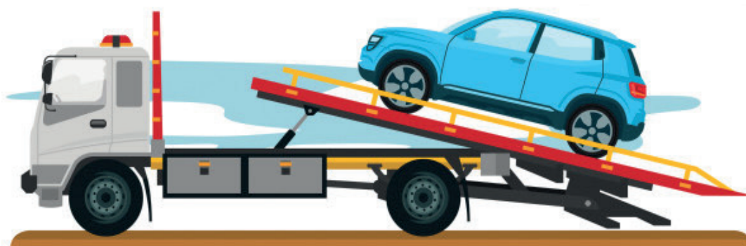
Figura 1. Carro sendo guinchado é um exemplo de plano inclinado: Ao utilizar uma rampa para transportar o carro, altera a intensidade, a direção e o sentido da força.
